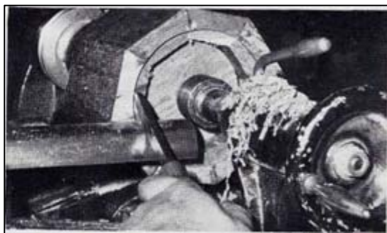
Fig. 11 (au centre, à droite). Ebauche montée sur tour avec tampon du côté de la contre-pointe.
