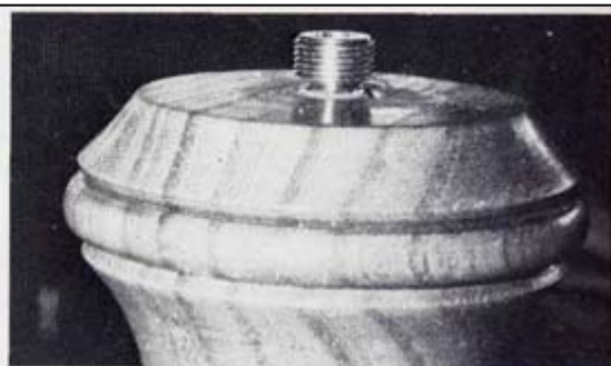
Fig. 14 (ci-dessus, à gauche). Table de tour réglée pour le perçage d'un socle de lampadaire pour le passage du fil.
