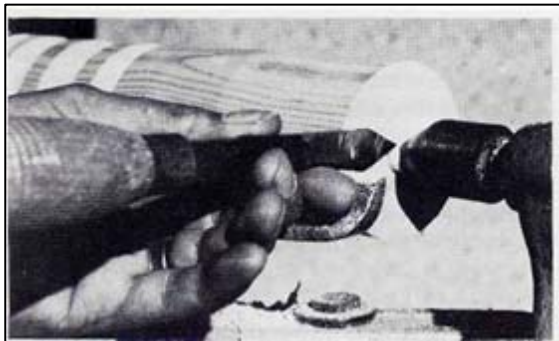
Fig. 13. Passes faites au grain d'orge sur le bout d'un cylindre. Il donne un fini assez grossier mais permet de dresser rapidement le bois de bout. Il doit toujours «indiquer dix heures» sur le cadran que forme la section du cylindre.
