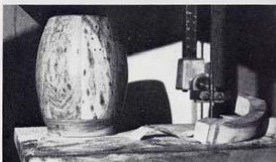
Fig. 13 (en haut, à gauche). Ajustage du fond et pose d'un morceau de contre-plaqué sur l'extrémité ouverte de l'ébauche afin de permettre la mise en place de la presse à main.
